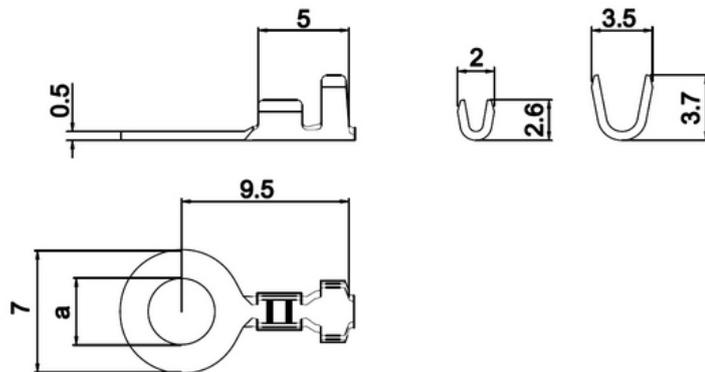
**RINGKABELSCHUH für M3,5 Außen-Ø7 mm, Länge 9,5 mm**
