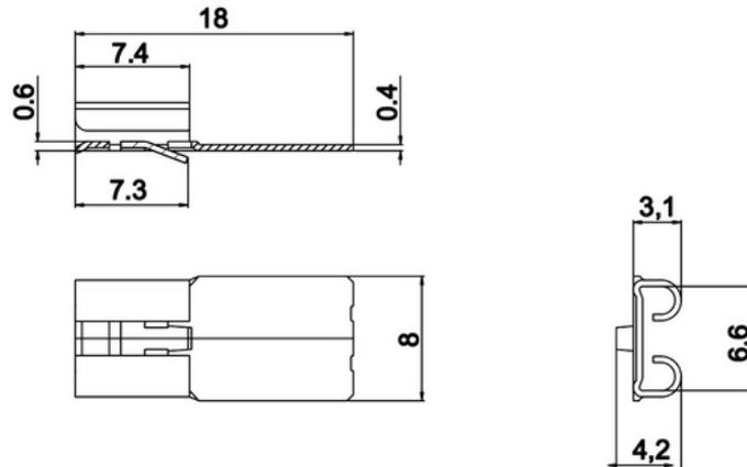
**FLACHSTECKHÜLSE 6,3 x 0,8 mit Rastnase Einzelteile**
