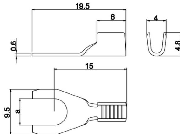
**GABELKABELSCHUH für M4 Außenmaß 9,5 mm, Länge 15 mm**
