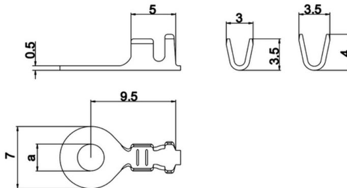
**RINGKABELSCHUH für M3 Außen-Ø7mm; Länge 9,5 mm**
