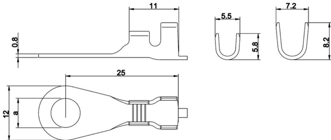
**RINGKABELSCHUH für M4 Außen-Ø12 mm; Länge 25 mm**
